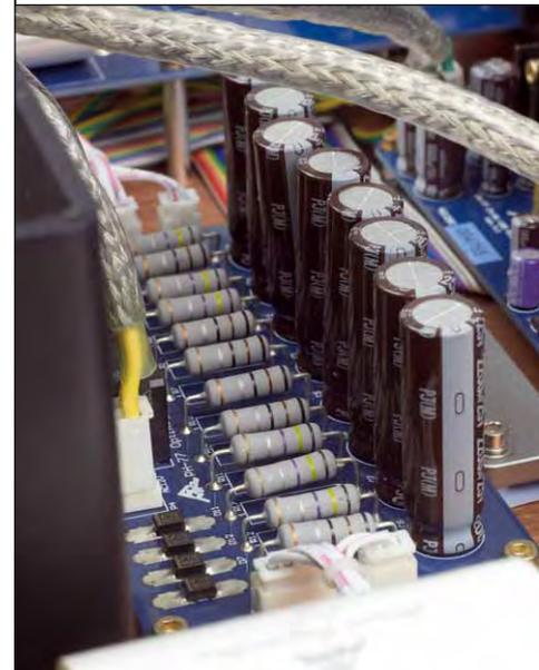
*Gleichrichtung und Siebung: Bei AMR ist man vor hochmodernen Bauteilen nicht bange, wie die SMD-Gleichrichterdioden am vorderen Bildrand zeigen*
