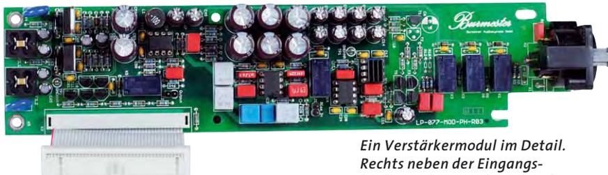
*Ein Verstärkermodul im Detail. Rechts neben der Eingangsbuchse sieht man die Relais für die Impedanzumschaltung*
