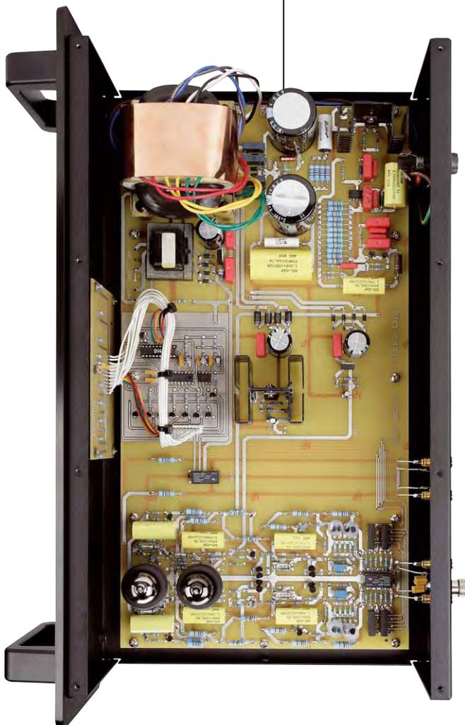
*Der Aufbau des Gerätes zeugt von langer Erfahrung. Auffällig gegenüber dem Vorgänger: die geänderte Schaltung mit nur noch zwei statt vier Doppeltrioden*
