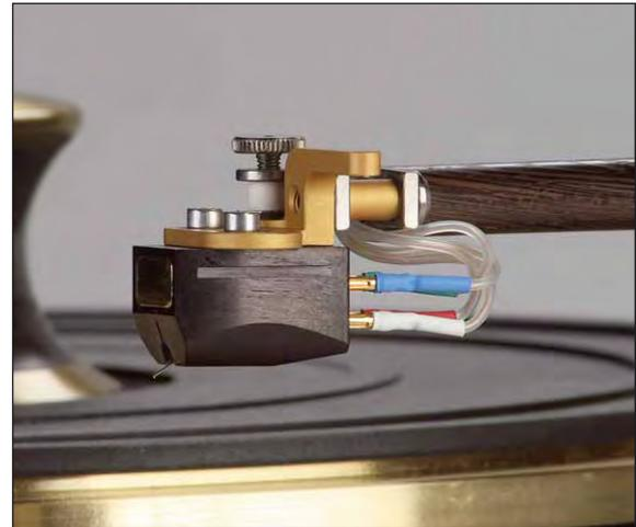
*Interessante Azimutverstellung: Der Tonabnehmer kann vorne am Headshell per Stellschraube gekippt werden*
