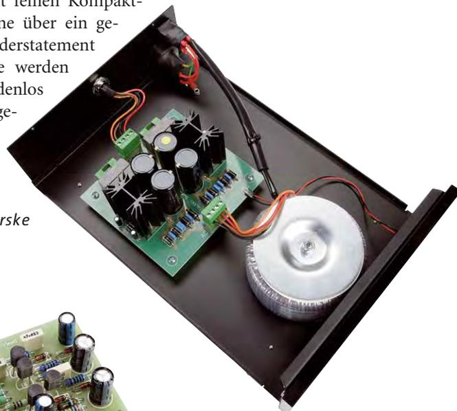
*Oben: Das Zusatznetzteil verfügt über eine vielfache Stromlieferfähigkeit der Originalversorgung*
