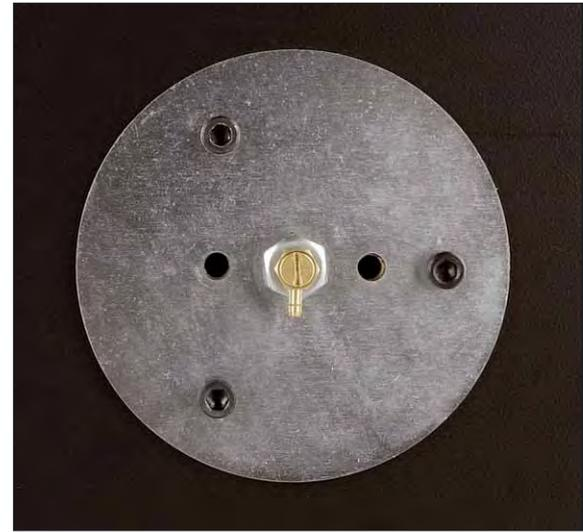
*Unter dem Lagerdorn findet sich der Flansch der Vakuumansaugung, an den einfach der Luftschlauch von der Pumpe aufgesteckt wird*
