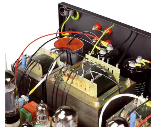
Innen sieht fast alles aus wie früher: Offene Trafos und teilweise freie Verkabelung. Die Siebkondensatoren sind gegen Resonanzen vergossen
